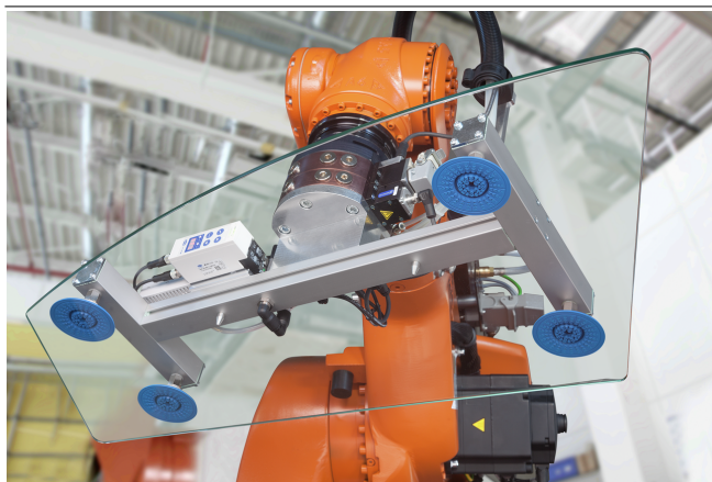
Центральная генерация вакуума компактными эжекторами X-Pump SXPi / SXMPi
